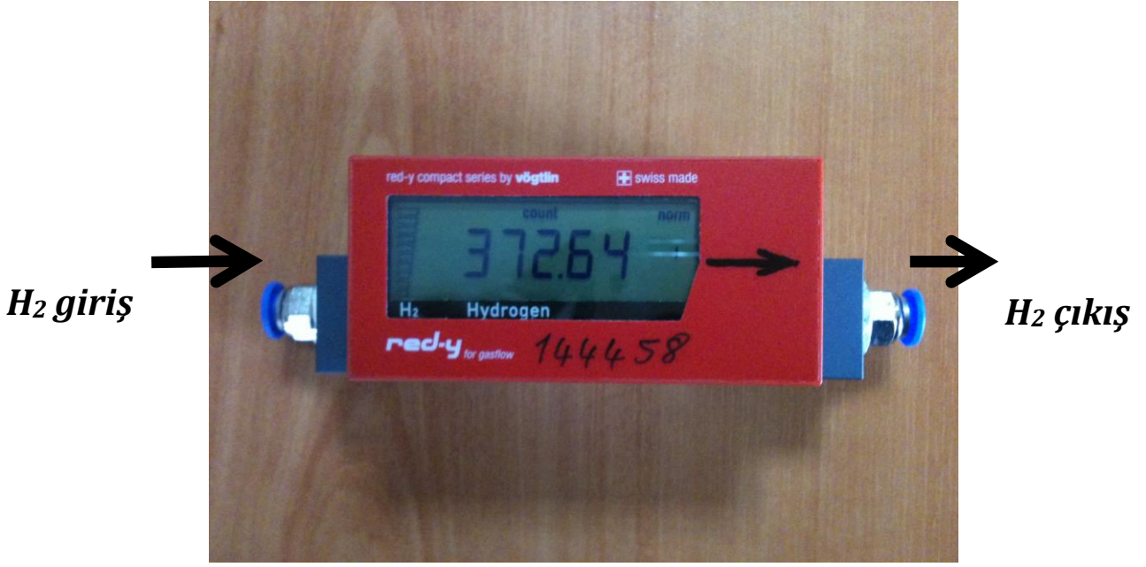
Şekil 10. H 2 akış ölçerin gaz akış yönünde bağlanması.
