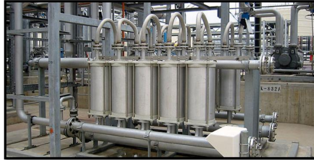
Şekil 3.4. Seçici geçirgen Membran filtre teknolojisi
